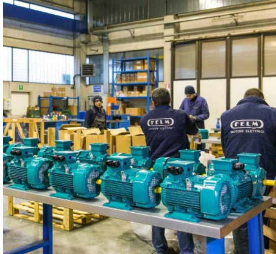
Linea assemblaggio motori bassa tensione presso la sede di Inveruno (MI) di Felm.
